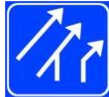
figuur B2.55: rijstrookindeling met taper
